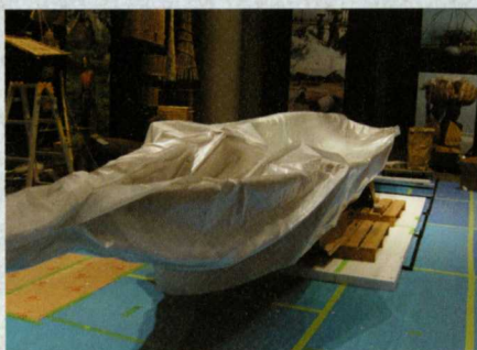
(写真3) 防湿プラスチックシートで漁船を密封した後、シート内を脱気する
