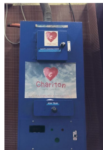
公衆トイレに設置された使用済みパッド処理機。入ると焼却処理をする(マハーラーシュトラ州、2019年)
