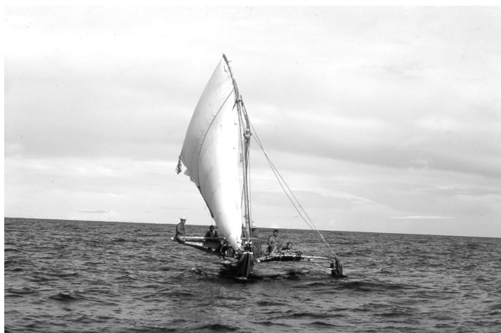
写真1 外洋を航海するカヌー。風を腕木側から受けてバランスをとって進める。(サタウル島、1978年)
