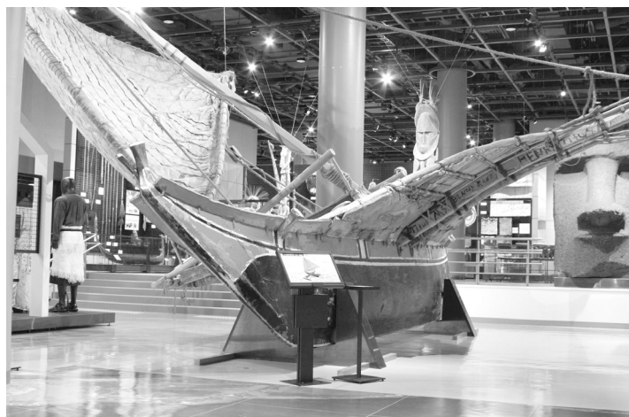
写真2 オセアニア展示場のチェチェメニ号。パンダナスの葉で編んだ製帆をはじめ、すべて島産の材料で建造。
